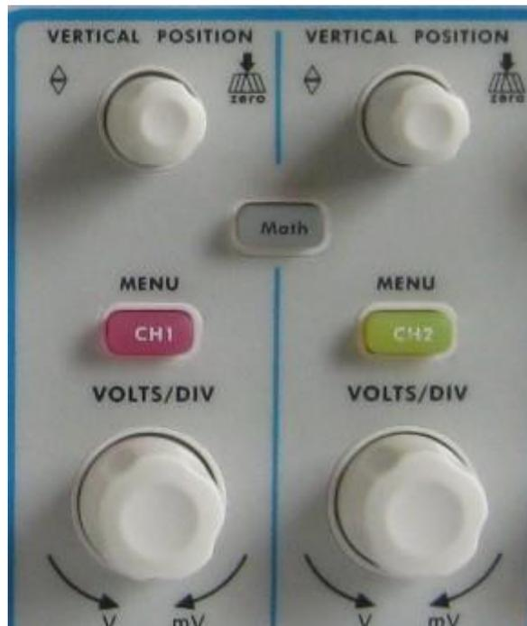
**Рис. 8** Элементы управления вертикальной разверткой
