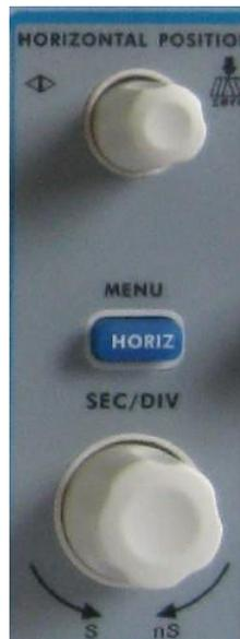
**Рис. 9** Элементы управления горизонтальной разверткой
