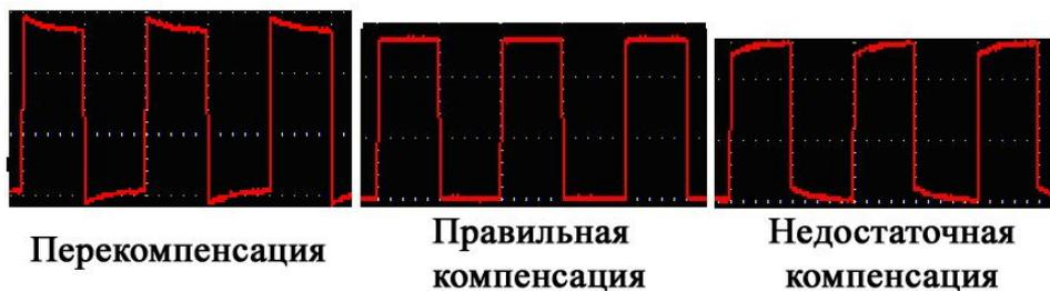
**Рис. 4** Отображаемые осциллограммы компенсации пробника
