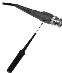
**Рис. 5** Настройка пробника
